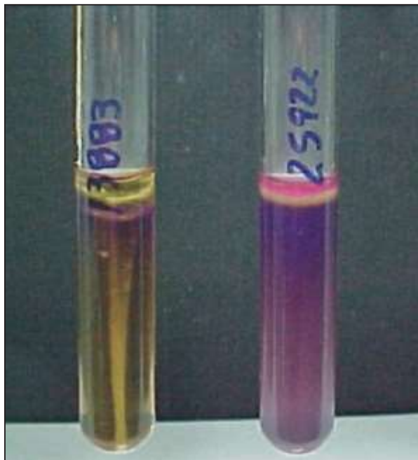
Figura 8: Meio MIO. À esquerda prova da ornitina e da motilidade negativa; à direita as duas provas positivas.
