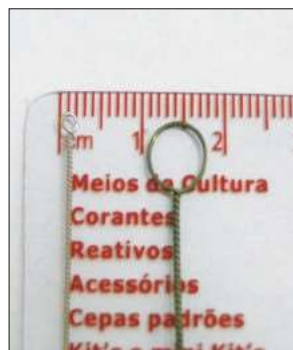
Figura18. Diâmetro da alça calibrada de 10 \mu L.
