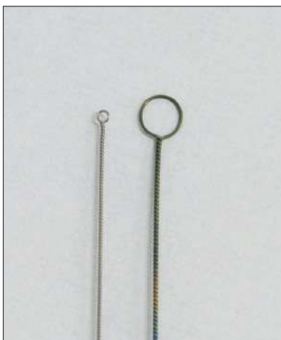
Figura 17. Comparação de tamanho entre as alças de 1 \mu L e 10 \mu L.
